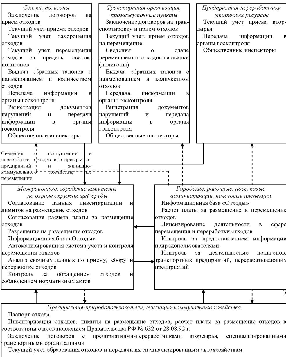
**Рис. 1. Схема учета, контроля, образования и перемещения отходов:**
